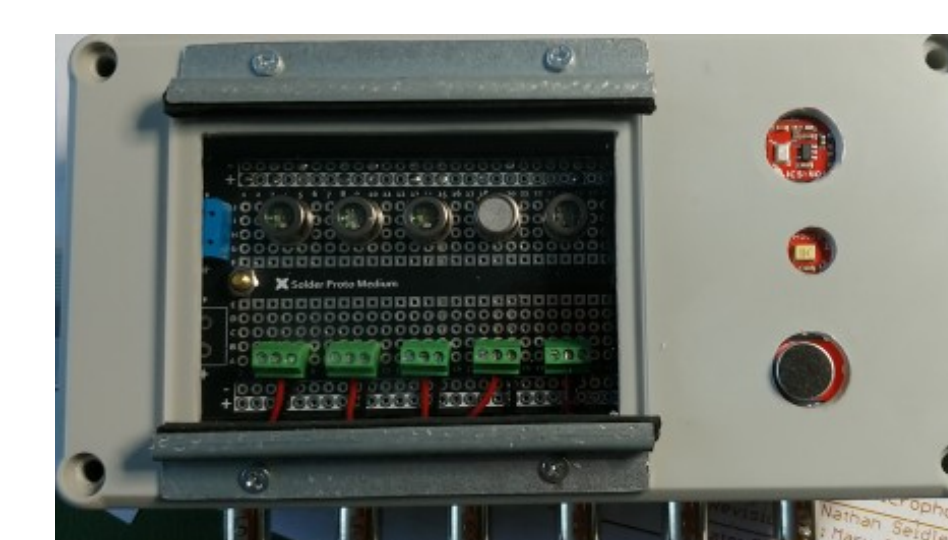
Rys. 5. Skrzynka z czujnikami.
